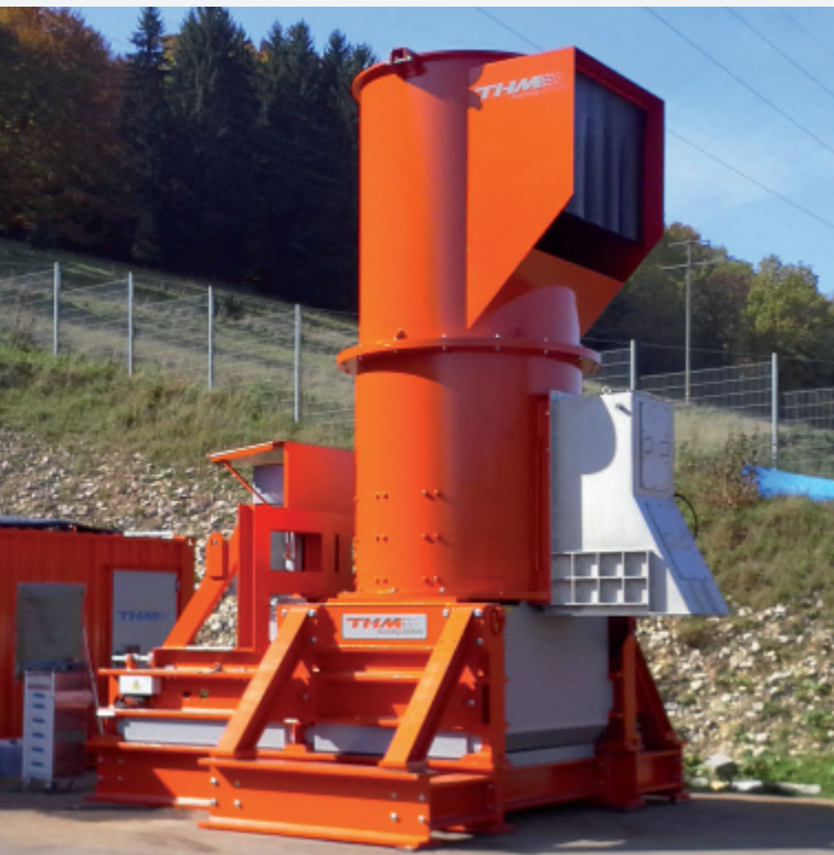
Das neue Herzstück der Korn Recycling GmbH, der TQZ Querstromzerspaner
