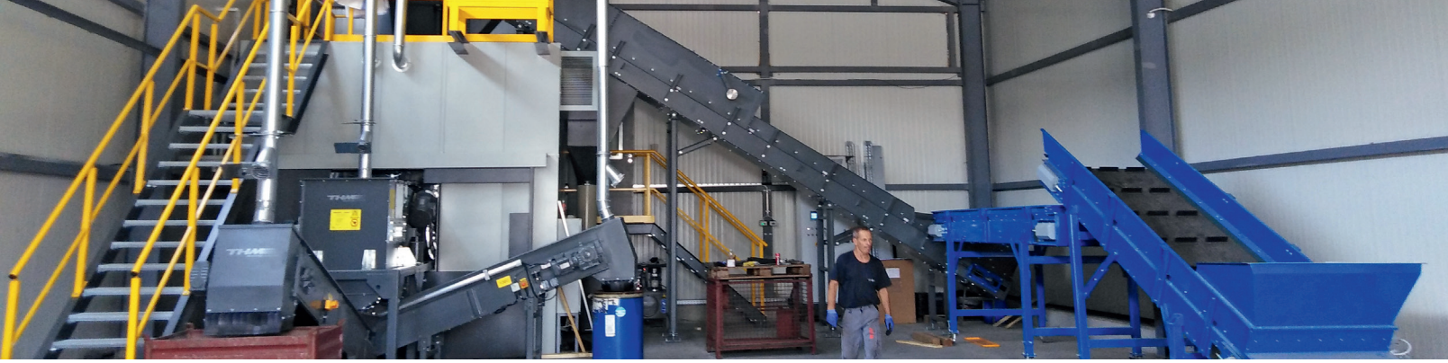
Kombinierte Anlage zum Recyceln von entweder Autokatalysatoren oder Elektroschrott
